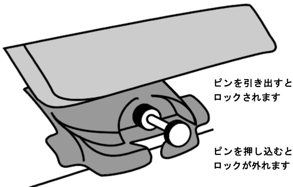
2. トパーズ HD の XY テーブルが動かないように、XY テーブルのスライドバーをロックしてください。
