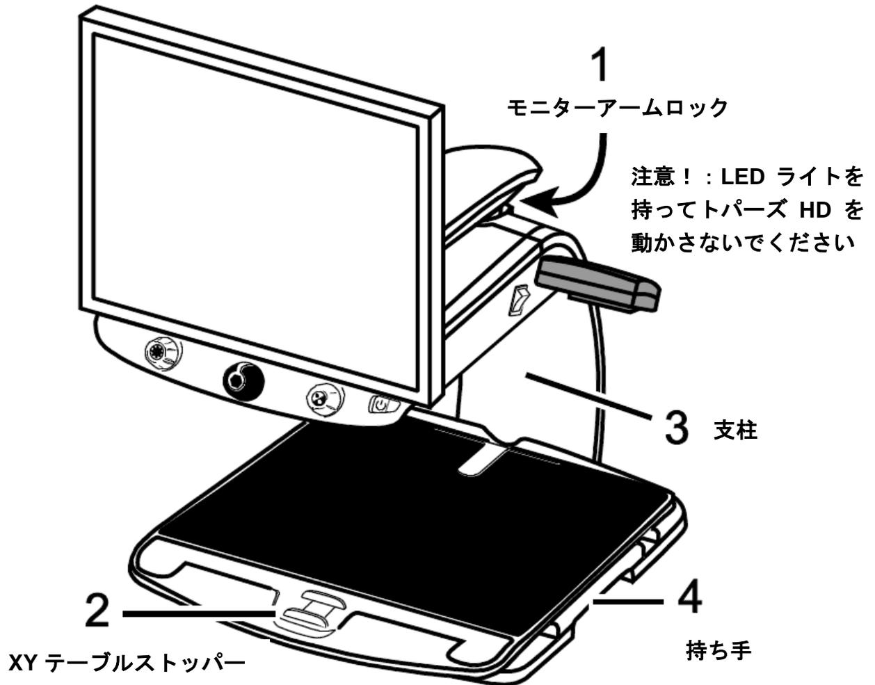
1. トパーズ HD を動かす際にはモニターが左右に動かないように、モニターアームロックのピンを引き出してモニターをロックしてください。
