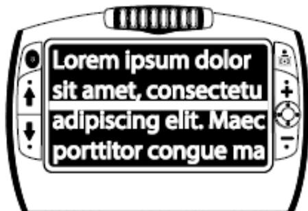
2. ラインを表示した状態で電源ボタン(緑/黄) ● を押しながら拡大ボタン(黄)の+または-を押すと表示されたラインを上下に移動することができます。
